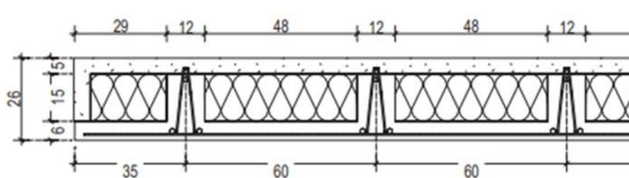
Figure : Coupe du plancher dalle BB complet. Epaisseur Dalle BB : 21 cm.
