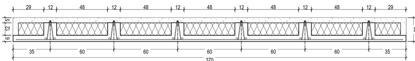
**Figure 4: Dalle BB standard de largeur 3.70 m**
