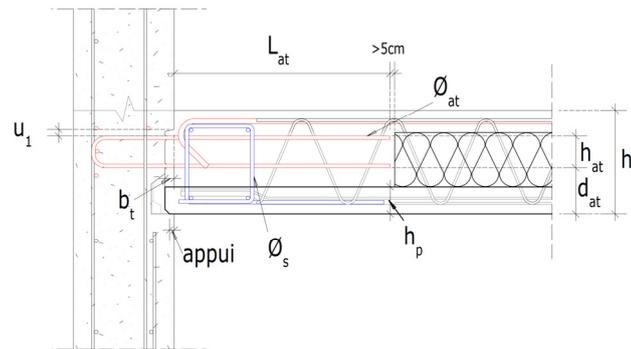
**Figure 27: représentation d'un plancher avec système LPPVE**
