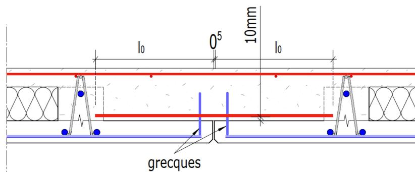
**Figure 11 : Joint couturé avec enlèvement du pain de bois entre deux Dalle BB – Configuration D**
