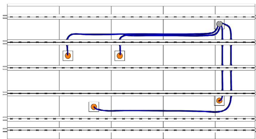
Localement des passages à travers les nervures peuvent être prévus. Toutes ces traversées doivent être prévues lors de la conception de la Dalle BB par le Bureau d'Etude de l'industriel dans les conditions suivantes :
