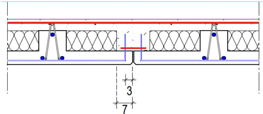
**Figure 9: Joint couturé plus couvre-joint entre deux Dalle BB – Configuration B**
