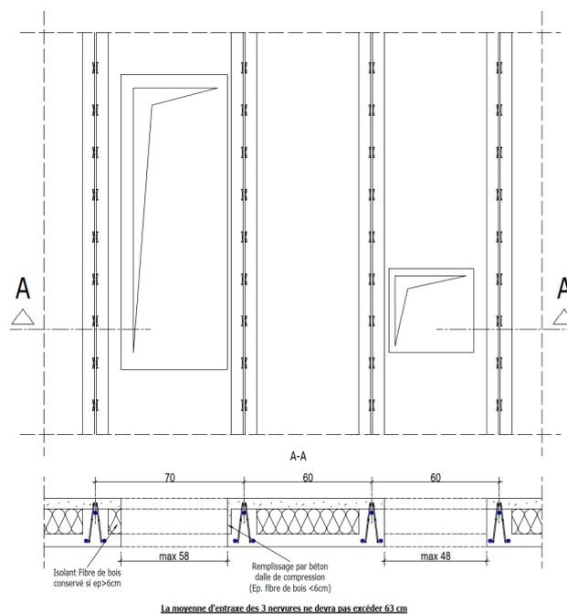
**Figure 14: Représentation d'une trémie inférieure à 58 cm**
