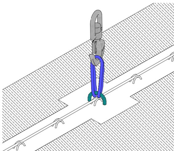
**Figure 22: Elargissement de la nervure**
