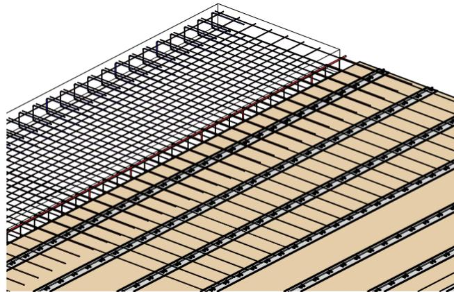
**Figure 13: Cas des porte-à-faux parallèles aux nervures**
