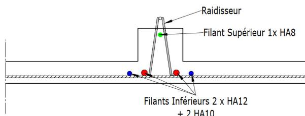
Figure 6: Exemple de ferrailage d'une nervure BB15 avec étai, pour une portée de 6,50m, et une charge de 100+150kg/m<sup>2</sup>
