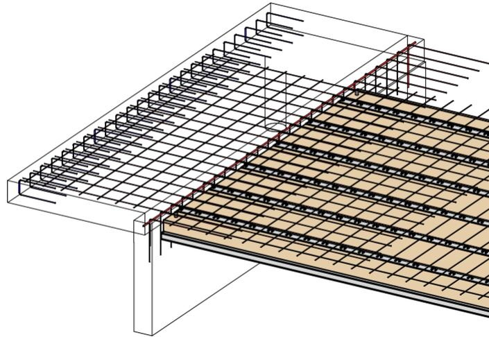
**Figure 12: Cas des porte-à-faux en prolongement des nervures**
