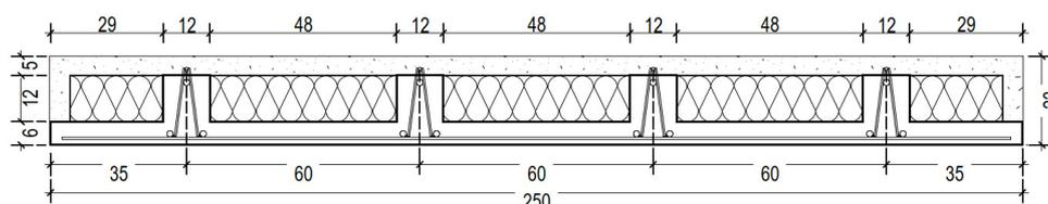
**Figure 3: Dalle BB standard de largeur 2.50 m**
